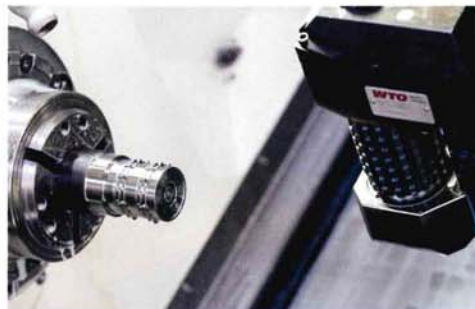
Zu der anspruchsvollen Bearbeitung der Ritzeladapter gehört auch das Abwälzfräsen.
